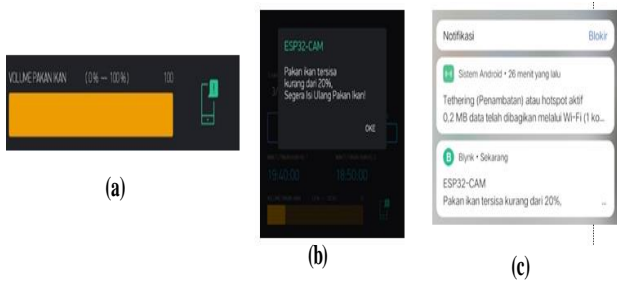
Gambar 7. Proses pengujian Monitoring Volume Pakan Ikan dan Sensor Ultrasonik HCSR04, (a) Volume pakan ikan pada aplikasi (b) Notifikasi sisa pakan ikan (c) Notifikasi tetap terkirim walaupun aplikasi tidak dibuka.
