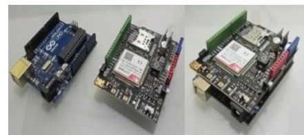
Gambar 11. Pemasangan Arduino Uno & SIM7000
