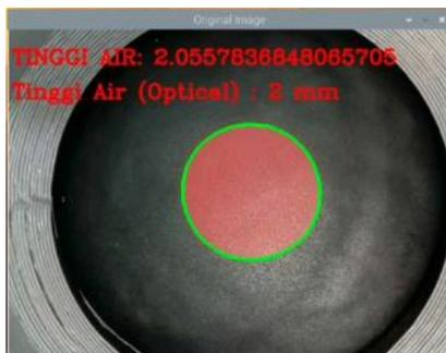
Gambar 13. sampel dari hasil pengukuran ketinggian air dengan menggunakan dua metode pengukuran yaitu image processing dan optical liquid water level.
