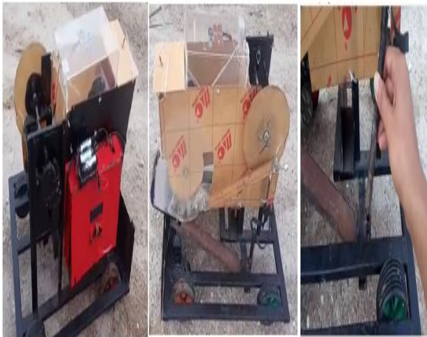
Gambar 5. Purwarupa Alat Tanam Jagung dengan Kontrol Jarak Tanam dan Kualitas Biji Berdasarkan Ukuran
