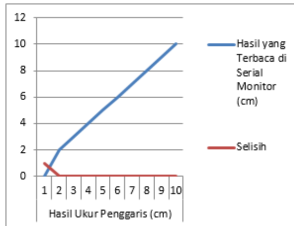
Gambar 6. Hasil pengujian sensor ultrasonik HC SRF04
