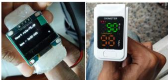
Gambar 13. Hasil pengujian sensor MAX30100 dan pulse oximeter medis
