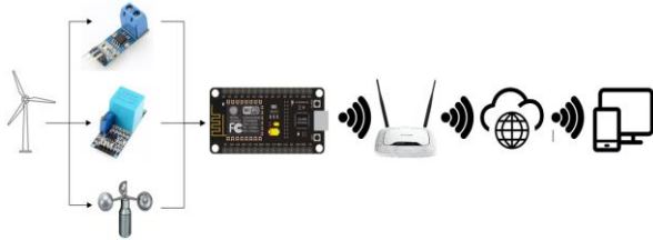
Gambar 2. Arsitektur perancangan perangkat keras
