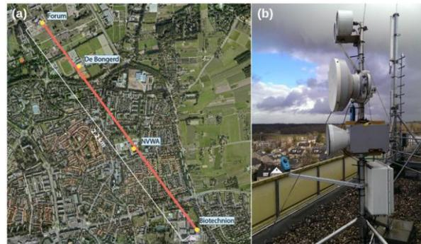
Gambar 4. (a) Lintasan *microwave link* ditandai dengan garis merah dengan "Forum" sebagai sisi penerima, (b) Tiga antena transmiter di atap gedung "Biotechnion".
