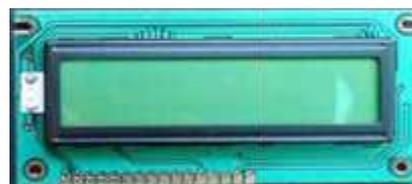
Gambar 2.11 Bentuk Fisik *Liquid Crystal Display (LCD)* 16 Karakter X 2 Baris
