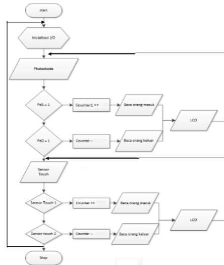
Gambar 3. Flowchart sistem penghitung jumlah pengunjung
