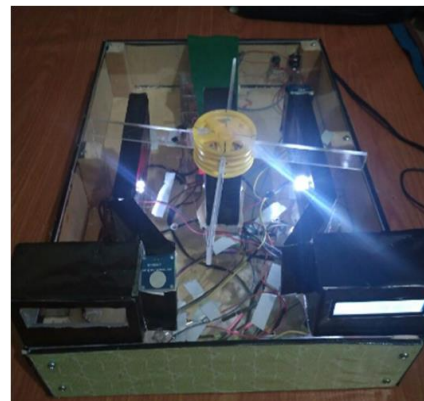
Gambar 4. Prototype Alat penghitung jumlah pengunjung di dalam kebun binatang
